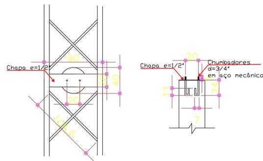
Detalhes fixação estrutura metálica nos blocos de ancoragem
