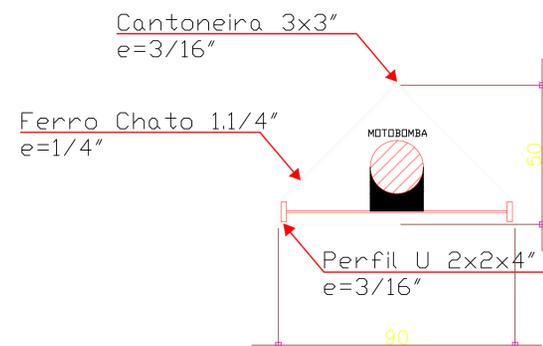
Seção transversal da estrutura metálica da captação água bruta
